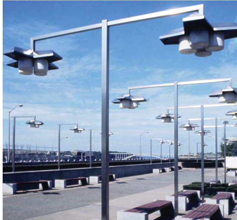
Figura A Postes de luz de acero inoxidable 316 con una superficie tersa, muestran un buen comportamiento en la mayoría de las aplicaciones costeras. (Crédito de la fotografía: AISI)
