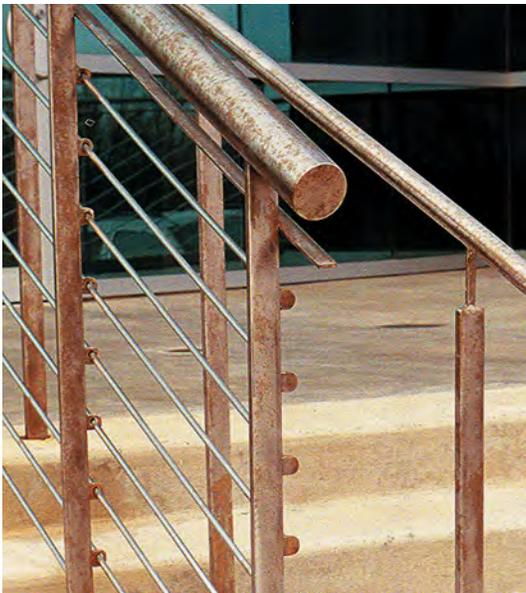
**Figura B** Un acero inoxidable grado 304 con un acabado rugoso fue la peor elección para el pasamanos expuesto a bruma de un camino donde se utiliza sal para el deshielo. Una limpieza puede remover las manchas, sin embargo, volverán a aparecer año tras año. (Crédito de la fotografía: TMR Stainless)
