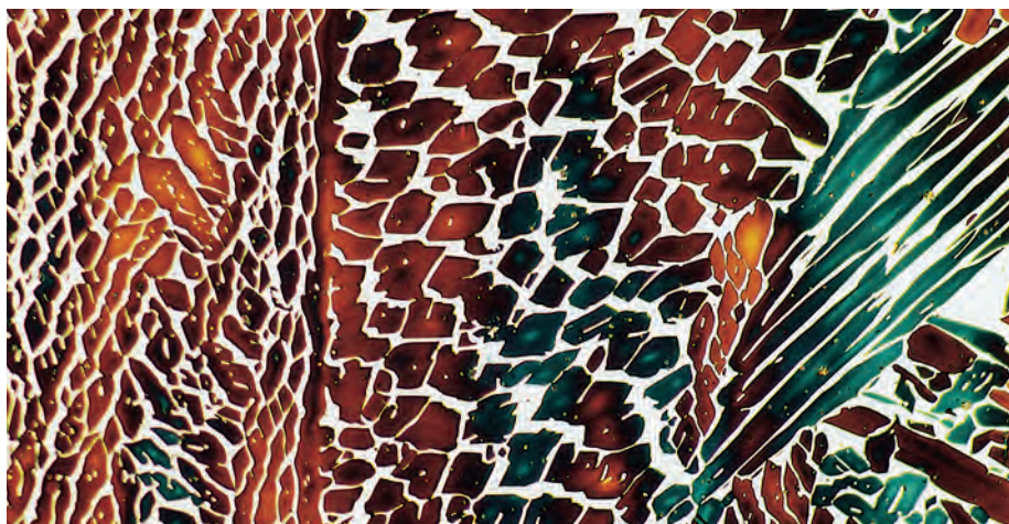
Estrutura metalográfica do metal de solda duplex 2205, 500x. © Lincoln Smitweld bv
