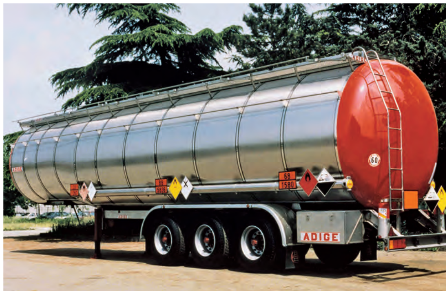
Caminhão cisterna para transporte de asfalto de aço inoxidável lean duplex. © Outokumpu
