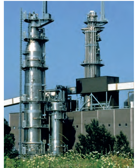
Torre de impregnação e digestão contínua de polpa de sulfato em aço duplex 2205, Sodra Cell Mönsterås, Suécia. © Kvaerner Pulping
