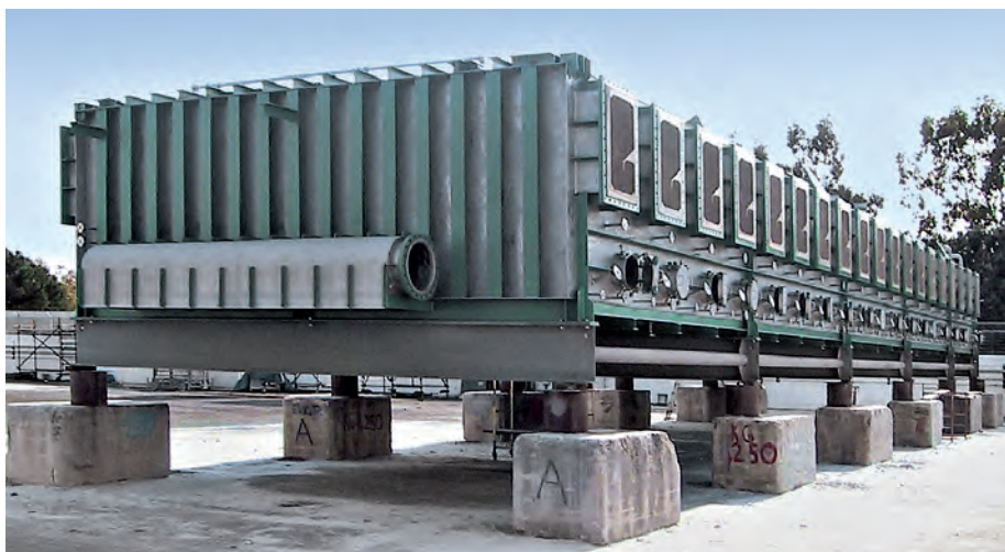
Unidade de dessalinização de água do mar por flash multi estágios construída com aço inoxidável duplex S32101 e S32205. © Outokumpu
