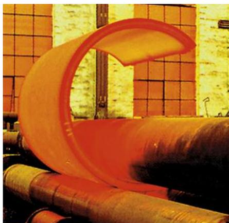
双相不锈钢板的热轧辊弯曲操作
