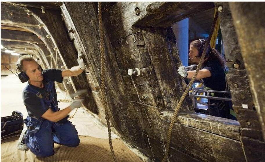
正在安装特超级双相不锈钢螺栓，保护瑞典的古沉船瓦萨战舰
