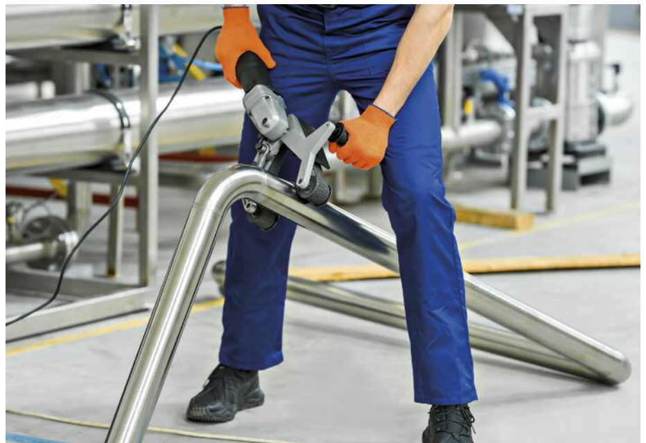
人工抛光不锈钢管，使焊缝与钢管饰面相融合。© Olya Humeniuk/Shutterstock.com
