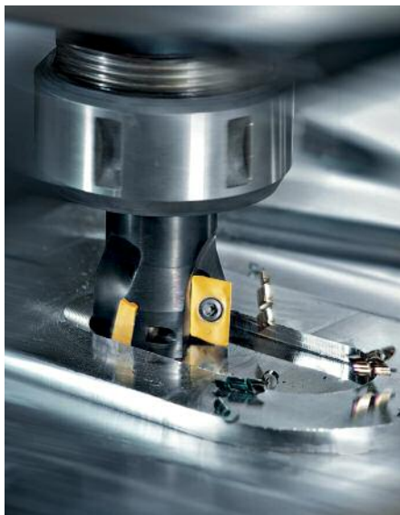
使用硬质合金刀具侧铣。© Seco Tools
