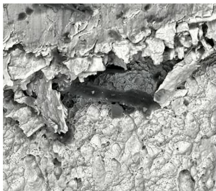
采用冲孔来穿孔会产生可见的磨光面和断裂面。钝工具造成的断裂面更粗糙，抛光面和断裂面的交界处出现金属重叠，这些孔更容易受到腐蚀。© Catherine Houska
