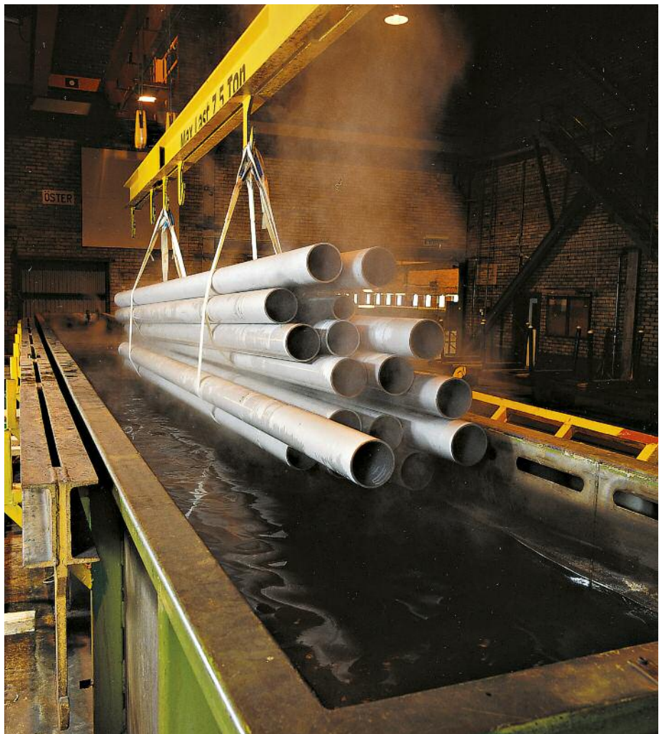
在任何热处理之前，表面脱脂是必不可少的清洁步骤。© Sandvik
