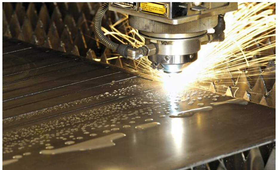
利用激光切割工艺快速切割不锈钢板。
