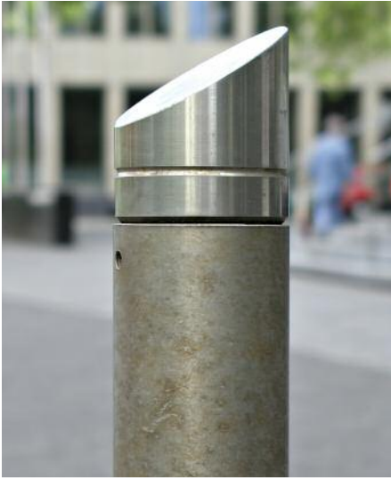
316不锈钢路柱暴露于过往车辆飞溅的道路盐中。底部为粗磨表面，顶部为更光滑的抛光表面，由此造成性能差异。© IMO A
