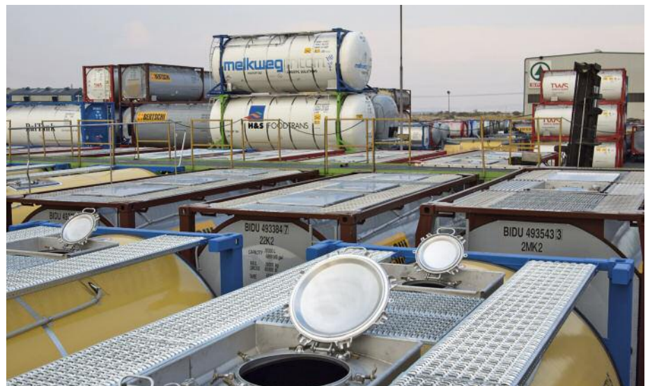
联运罐式集装箱通常由316型不锈钢制成。冷成型制成圆柱体。© IMO A
