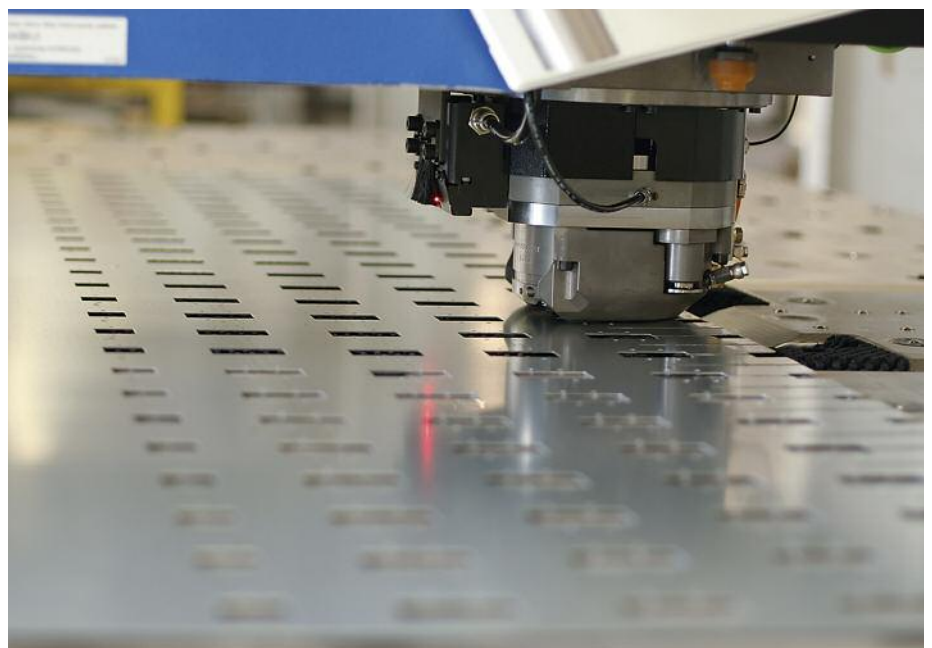
生产不锈钢孔板的冲孔操作。
