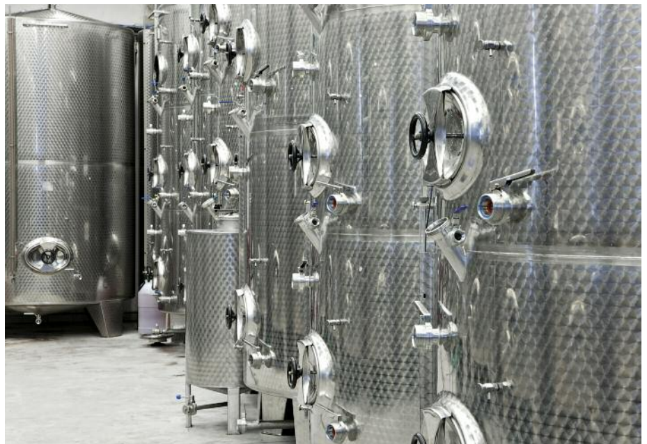
葡萄酒罐通常使用小圆形花纹抛光饰面，这种饰面具有卫生、易清洁，装饰性好，可隐藏凹痕和划痕。表面加工要求是设计的重要组成部分。© iStock.com/Josef Mohyla
