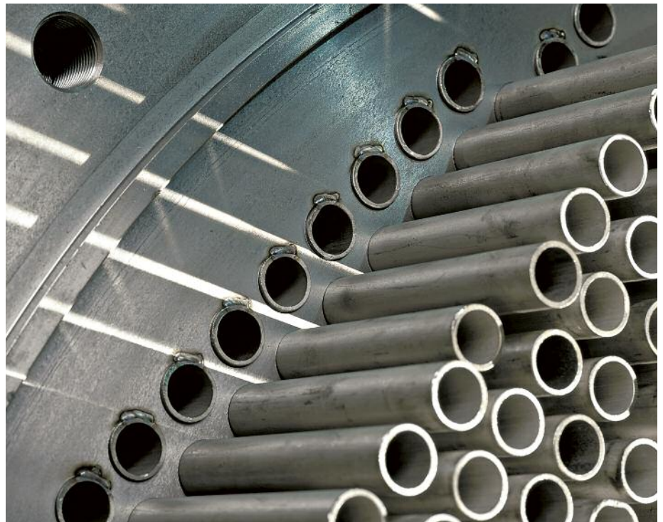
制造中的换热器管板。© Sandvik
