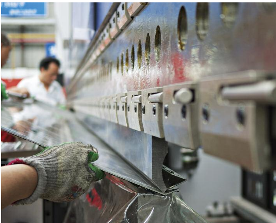
压弯机弯曲不锈钢板。© IMO A
