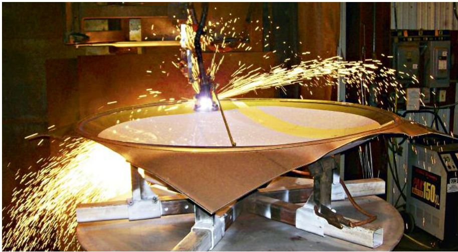
用于卫生用途的GTA焊接和液压成型的奥氏体不锈钢容器封头在进行等离子修整。 © DCI, Inc, St. Cloud, MN USA
