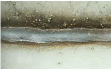
避免焊接飞溅和不平整焊缝。© Outokumpu
