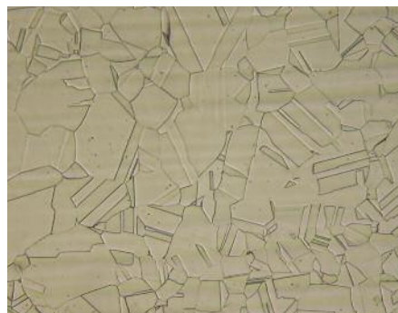
图4: 全部由奥氏体晶粒组成的6%Mo高性能奥氏体不锈钢的显微组织。 © TMR Stainless
