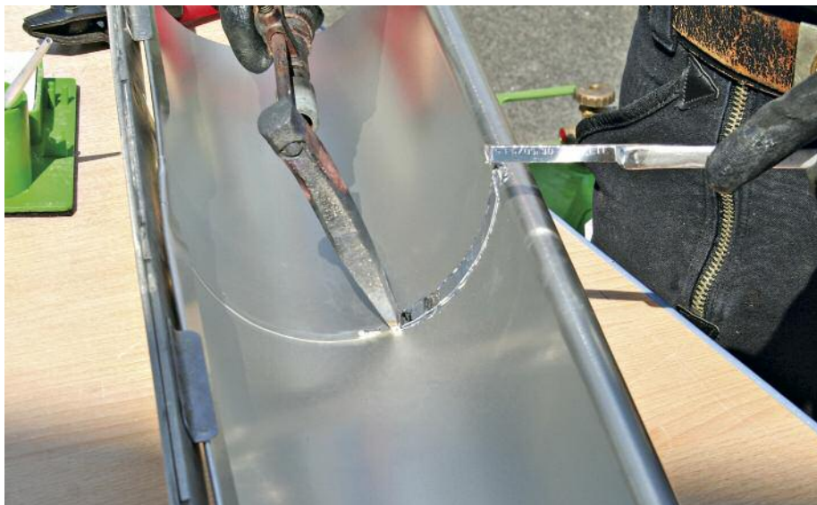
不锈钢钎焊并不难，但需要专用助焊剂。© BRANDT Edeltahldach GmbH
