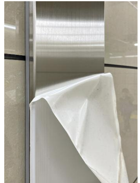
可剥离膜保护不锈钢表面，避免在制造和运输过程中划伤和沾污。© IMO A
