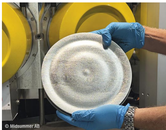
平板溅射靶材经多次生产循环后表面出现明显沟槽磨损，一旦过薄即被回收
