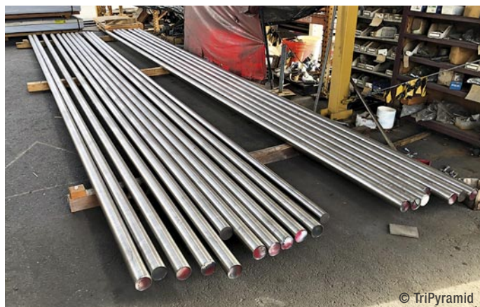
车间内待安装的2205双相不锈钢拉杆
