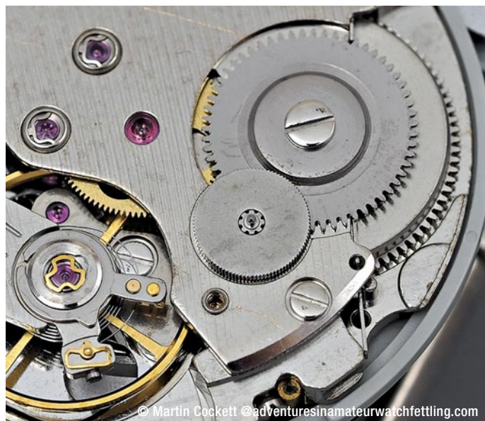
➤ 摆轮游丝（左）通过一系列齿轮连接到主发条（右），调节主发条的能量以秒为间隔恒定地释放。
