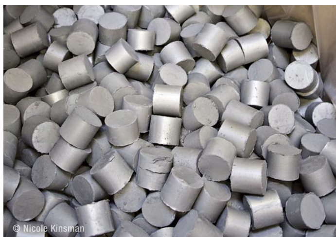
➤ 即使是研磨粉尘也被收集并压制成小球，便于在钢厂回收利用。
