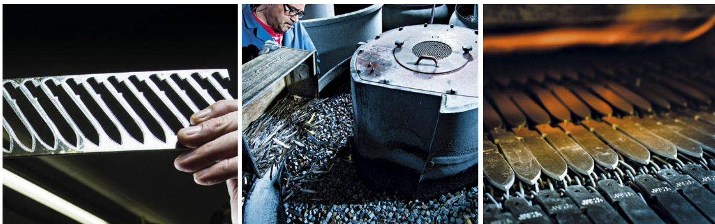
➤ 刀片是用不锈钢带冲压而成，剩下的废料可回收利用（左）在去毛刺机中用陶瓷研磨介质将未加工的不锈钢边缘滚磨光滑（中）每个刀片都经过热处理，使其既坚硬又有韧性（右）。©Victorinox
