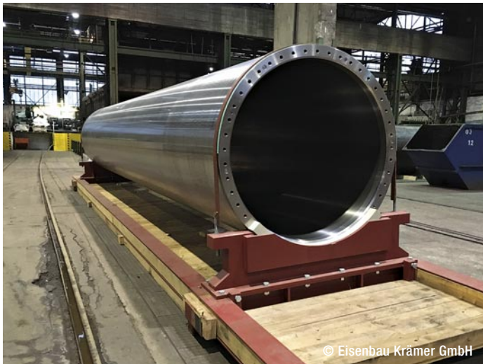
吸水辊体积庞大，但制造公差要求严格，这个3RE60 辊坯长12 米，直径近2米
